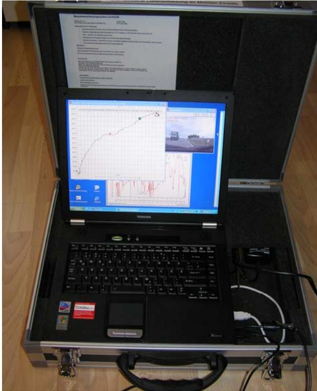
Bild 3: Messsystem winADAM (links) mit allen Sensoren in der Box
